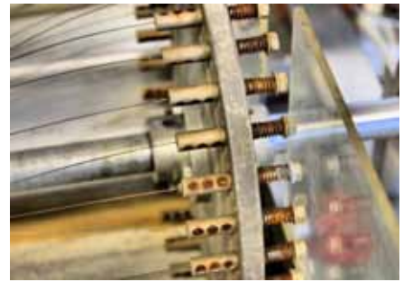
Druckfedern sind ein wichtiges Konstruktionsdetail, damit die Wärmekraftmaschine einwandfrei funktioniert. Sie dienen unter anderem der Kraftspeicherung.
