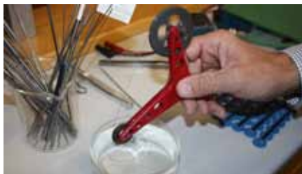
Schon Temperaturunterschiede von nur 40 Grad Celsius zwischen Wasser und Luft sorgen dafür, dass ein Demomodell, hier das Thermobile von Wang, anläuft und sich dauerhaft dreht.
