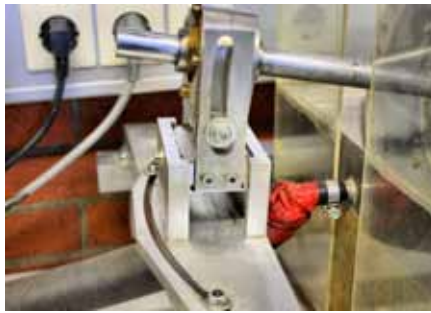
Nur eine schräg gestellte Scheibe ist in der Lage, eine Zugkraft in eine Drehbewegung umzuwandeln. Dazu wurde diese Konstruktion entworfen.
