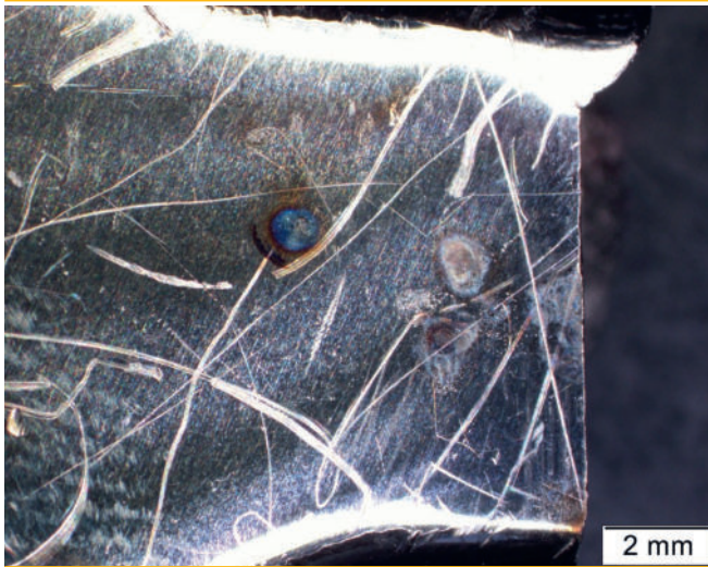
Bild 3: Detailaufnahme des Bruches der Hüftprothese mit wahrscheinlicher Bruchausgangsstelle. Farbliche Veränderungen der Oberfläche durch Hitzeeinwirkung (Stereomikroskop 6:1)
