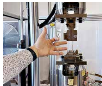
Welche Schwingungen hält das Stahlnetz aus? In diesem Gerät lässt sich genau diese Frage testen.
