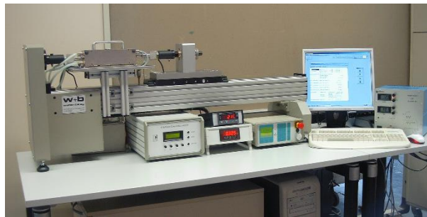
Abb. 1: Selbst entwickelte Prüfanlage zur FG-Bauteilprüfung bei Variation von Dehnung, Spannung, Temperatur
